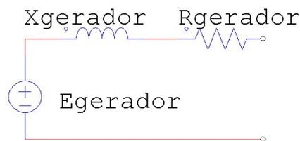
Figura 30: Modelo elétrico do gerador.
